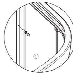
框架整体放上挡水石并靠墙，将内立柱孔位对准已钻孔位，用ST4X35螺钉锁入膨胀管内固定，最后盖上扣盖；
