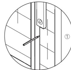
将铝型材放置在X位置处,使用水平仪使铝型材处于竖直状态,用铅笔在铝型材外侧划线;
