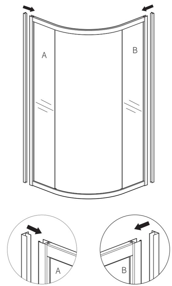
将内立柱套入整体框架;
