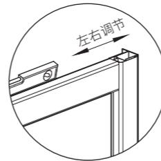
将水平仪放置于导轨上方，左右调节框体，使水平仪气泡处于中间位置；
