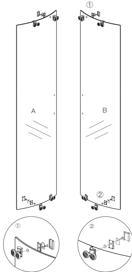
在两块玻璃门上安装上下滑轮(注意:图文印刷面朝内);
