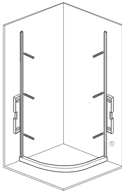
利用水平仪将内立柱竖直放置在划线位置，
