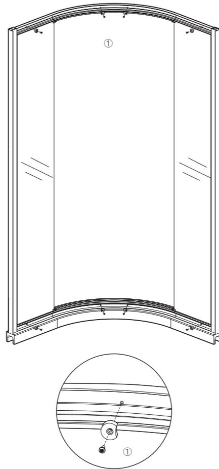
在上下滑轨的预留孔上安装8个缓冲块；
