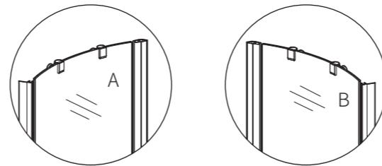
在玻璃门上安装F形挡水胶条和磁吸。
