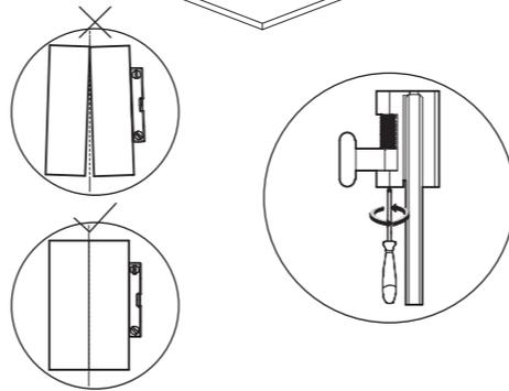
用十字螺丝刀调节对应上滑轮的螺丝,使两玻璃门处于垂直状态,且磁吸贴合紧密无缝隙。
