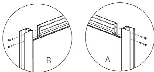
先用水平仪确保整体框架的水平度和垂直度,然后用ST3.5\*30的十字槽盘头螺钉将两根导轨和2块固玻组件锁紧(注意:玻璃上的图文印刷面朝内);
