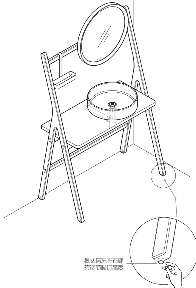
根据情况左右旋转调节脚钉高度
