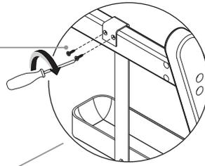
根据引孔位置，直接锁入螺丝
