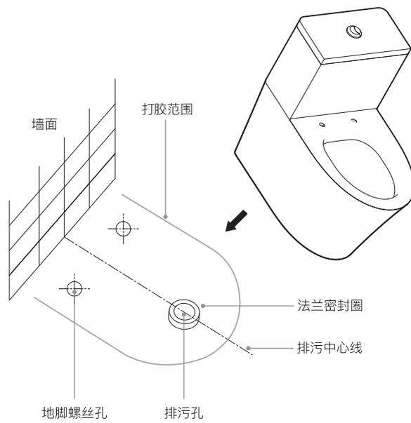
1. 将坐便器下水口对准排污孔管道，摆放好坐便器，标出地脚螺丝安装位置。
