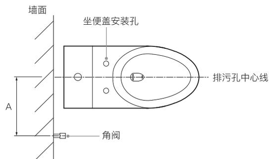
A:是指角阀到地面排污孔中心轴线的距离, 建议安装为200mm~250mm。
