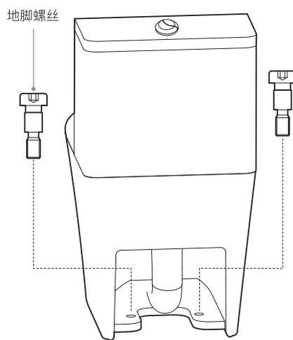
1. 将坐便器下水口对准排污孔后放上坐便器。
