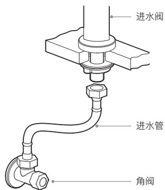
1. 用进水管将进水阀与角阀连接。
