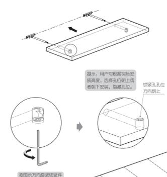
按图示方向安装膨胀管
