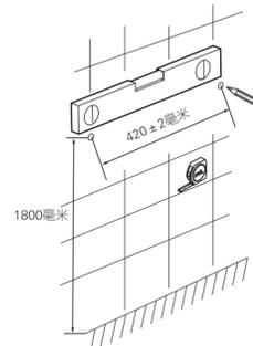
**03 钻镜柜安装孔**
